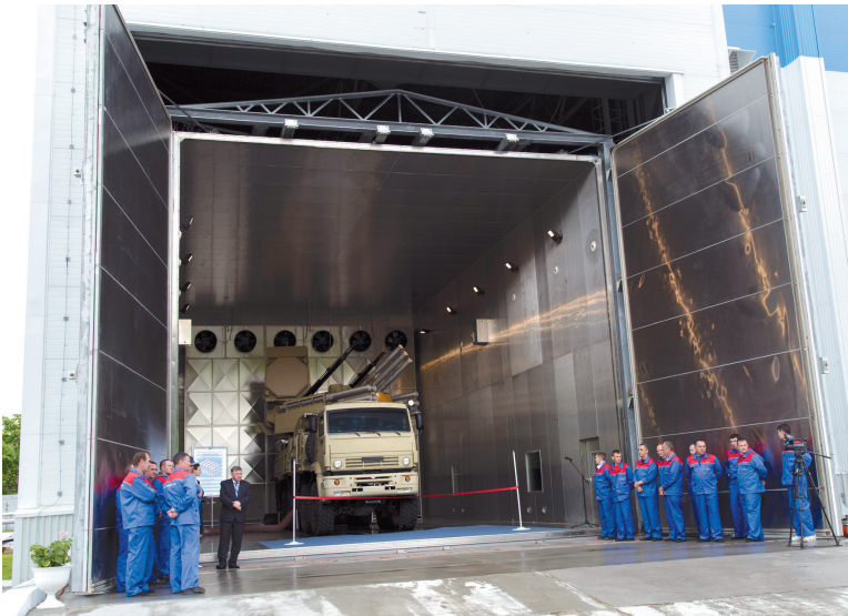
Климатическая камера позволит испытывать технику в условиях экстремальной температуры и влажности
