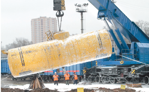
Цистерну вернули на рельсы с помощью крана
