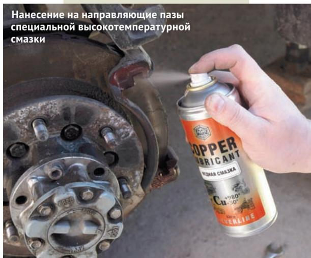
Нанесение на направляющие пазы специальной высокотемпературной смазки
