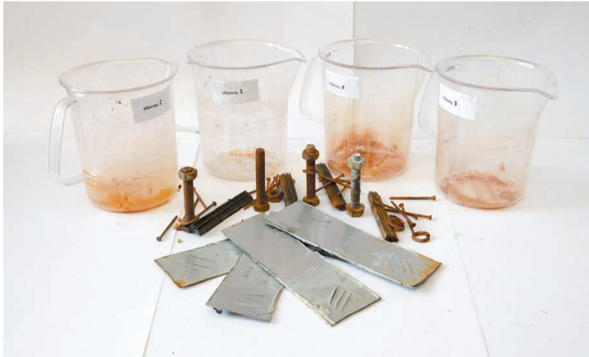
лось и легко отделяется от металла при поскабливании. Оцинкованный болт покрылся очагами коррозии, причем химической. Изделия из незащищенного металла также покрыты очагами химической коррозии. Резин-
