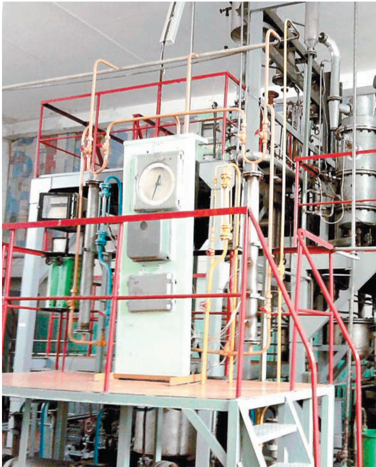
Ректификационная колонна в одной из лабораторий института позволяет получать бензиновую, керосиновую, дизельную фракции, мазут и углеводородный газ
