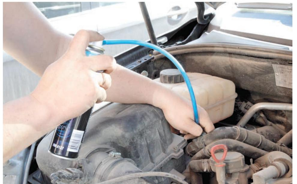
В зависимости от производителя состав распыляют или в полость для салонного фильтра – в дефлекторы воздуховодов, или в дренажную трубку
