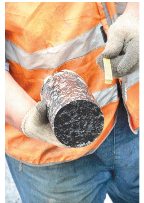
Рулетка позволяет отследить толщину слоев, а лабораторные исследования укажут их качество
