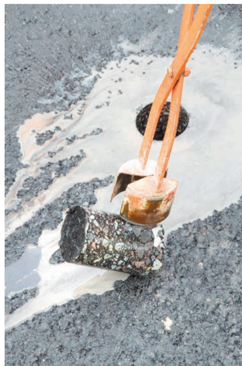
Отбор материала идет на всю толщину покрытия
