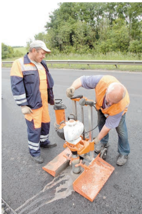
Керноотборник позволяет делать более щадящую цилиндрическую вырубку
