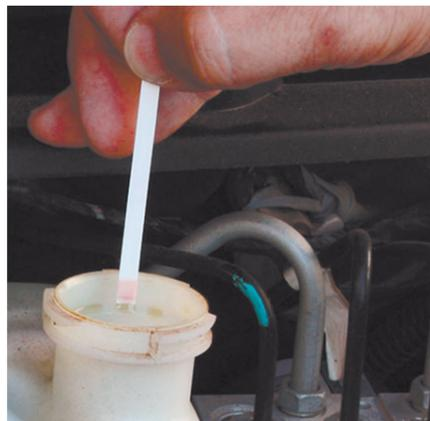
Проверка тормозной жидкости с помощью тест-полоски
