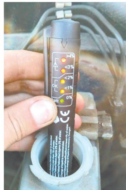
Прибор для проверки тормозной жидкости
