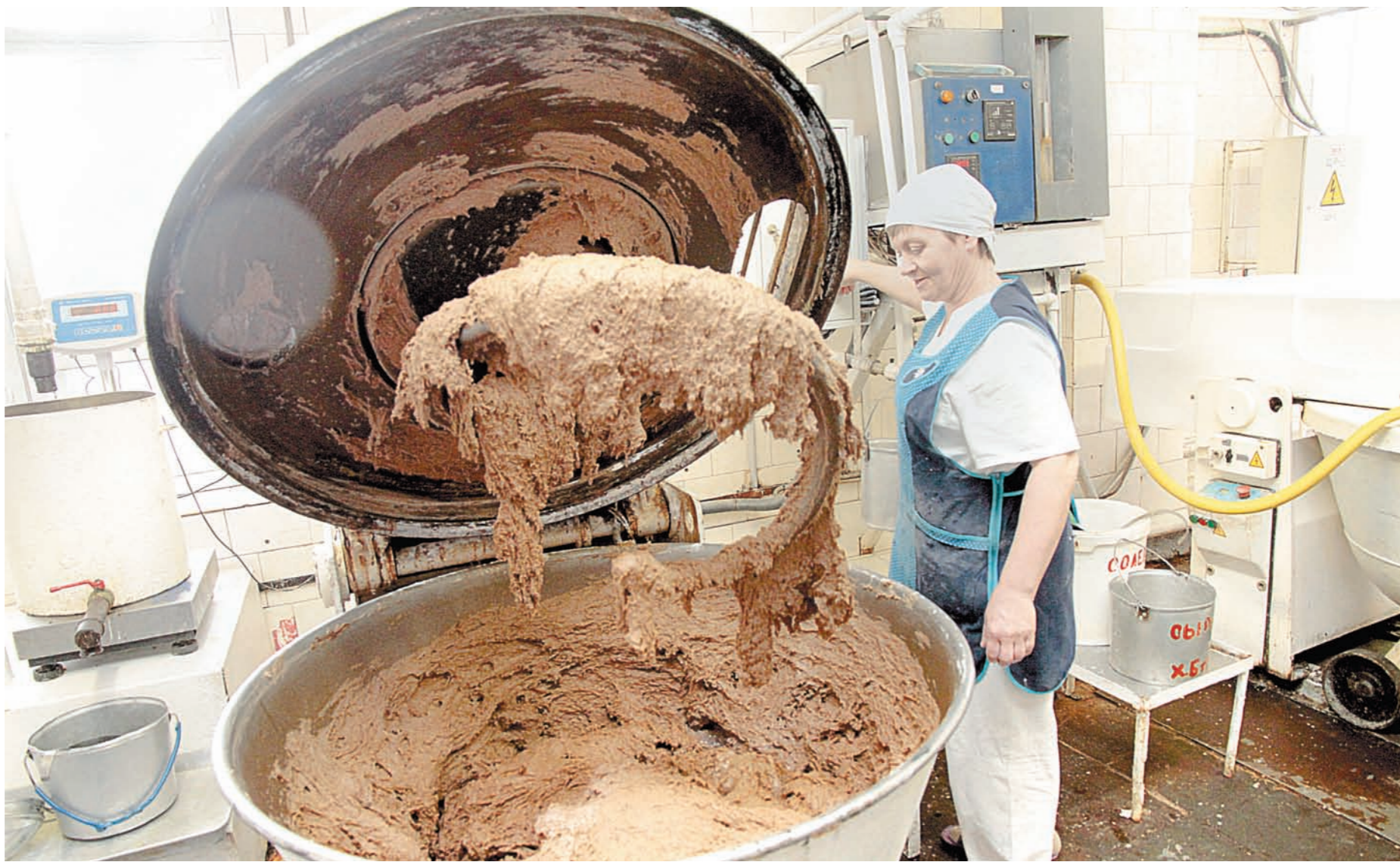
Процесс замеса заварного теста
