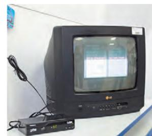
Запустите в настройках телевизора автопоиск каналов – и телевизор сам настроится на нужный эфирный канал. Поиск каналов также можно провести вручную. Для этого необходимо указать частоту канала, она зависит от зоны, в которой находится ваш населенный пункт. Узнать номер своего канала можно на сайте [rtрс.рф](http://rtрс.рф).
