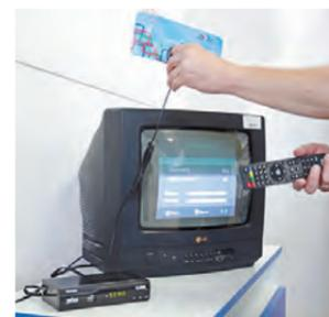
В большинстве цифровых приставок есть встроенный индикатор уровня и качества сигнала, что позволит оптимально настроить вашу антенну на прием цифрового эфирного сигнала.
