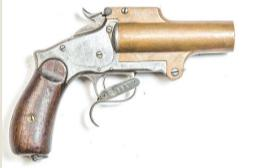
Тульский сигнальный пистолет, сконструированный на базе револьвера «Смит-Вессон» образца 1874 г. Конец XIX – начало XX в. Сталь, латунь, дерево, токарно-фрезеровочные работы, штамповка, литье, столярные работы. Калибр: 21,5 мм; длина общая: 21,5 см; длина ствола: 10,8 см.
